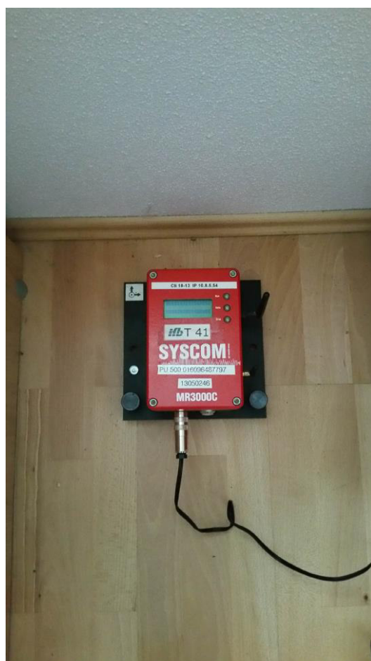
Bild 2: Blick auf das Erschütterungsmessgerät in der Messstelle M2
