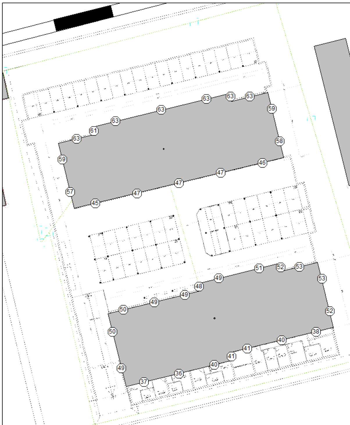
Bild 8: Gebäudelärmkarte 2. Obergeschoss, Schienenverkehrslärm tags in dB(A)
