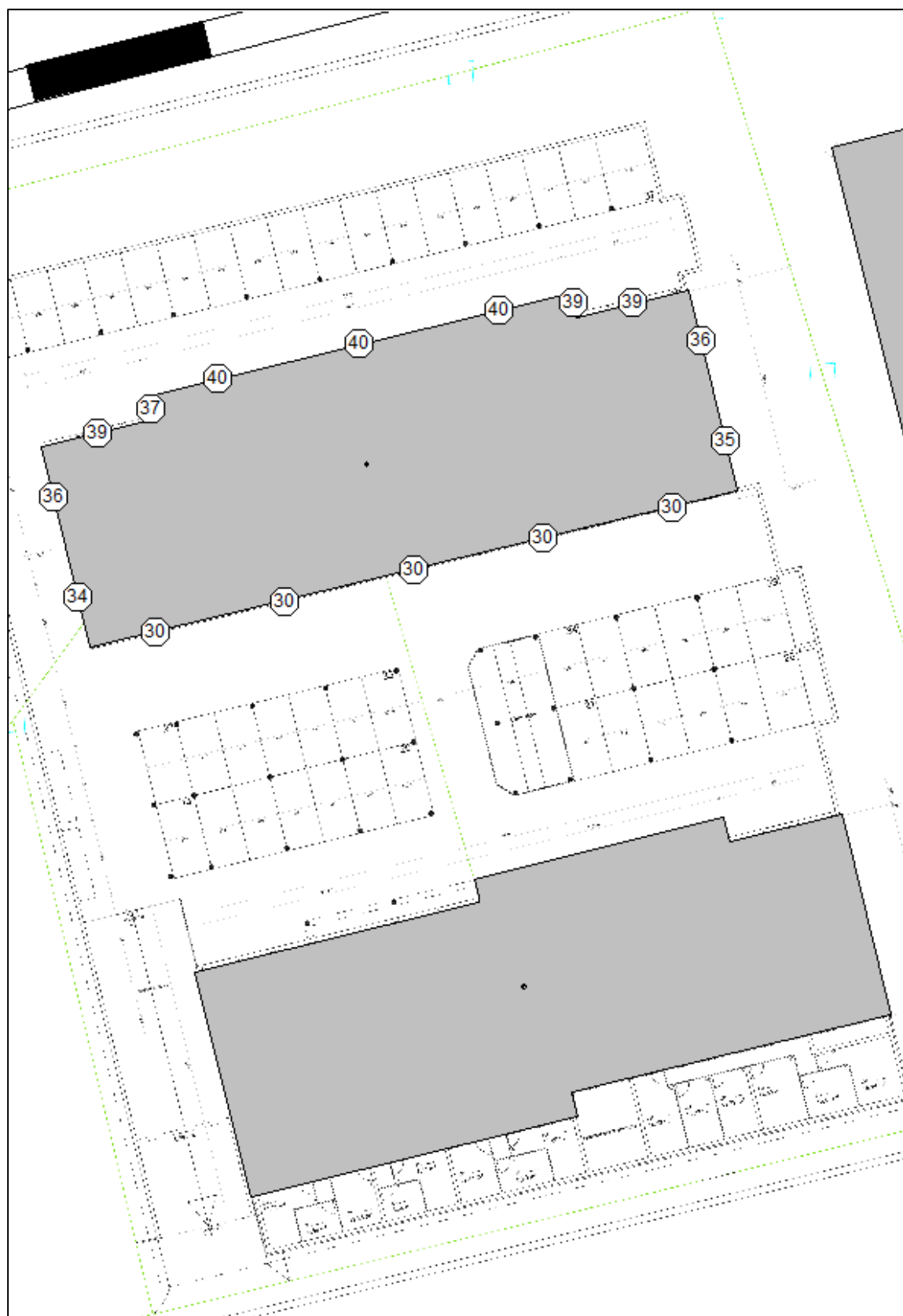
Bild 15: Gesamtes bewertetes Bau-Schalldämm-Maß R'_{w,ges} in dB im 3. OG
