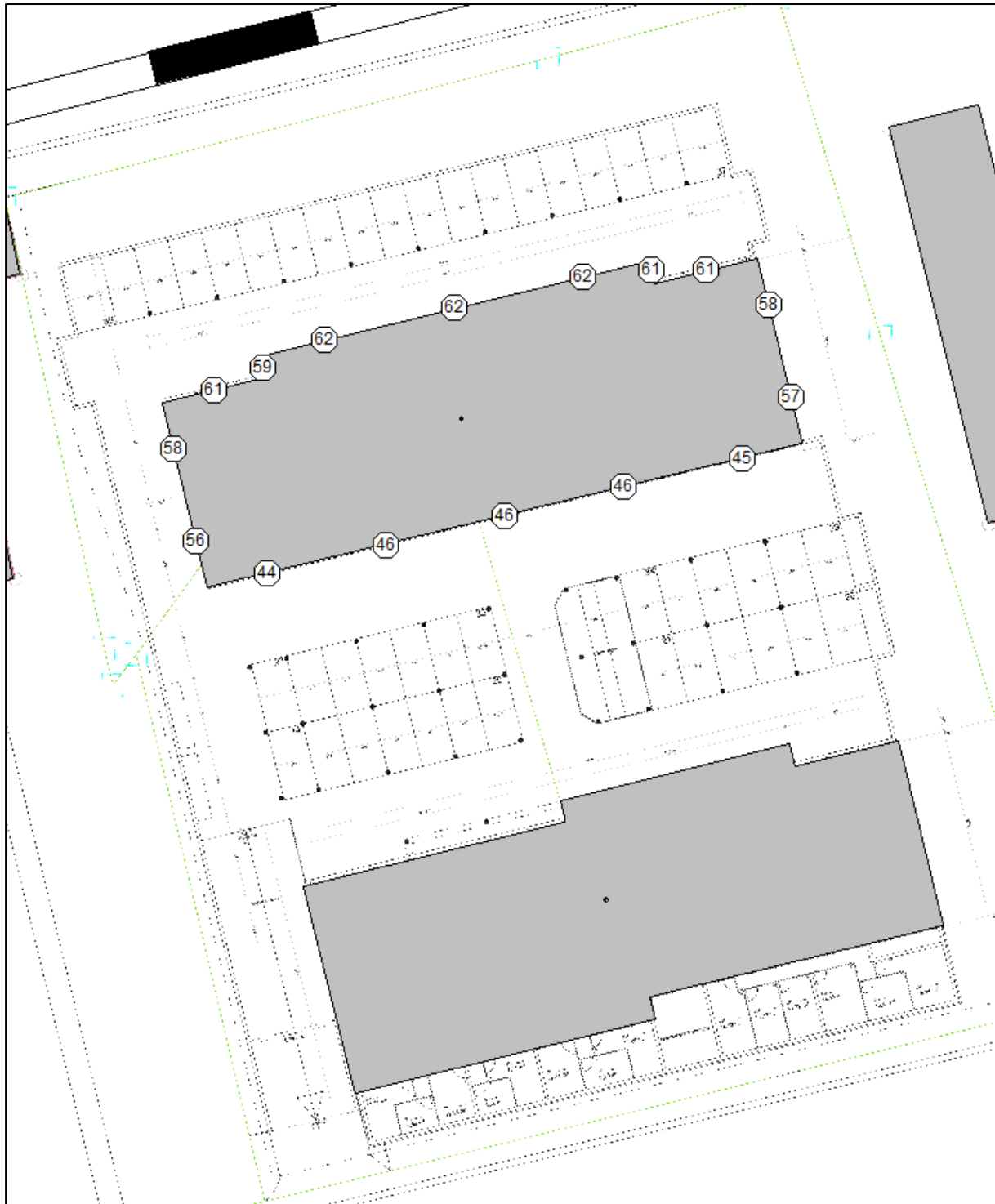
Bild 11: Gebäudelärmkarte 3. Obergeschoss, Schienenverkehrslärm nachts in dB(A)
