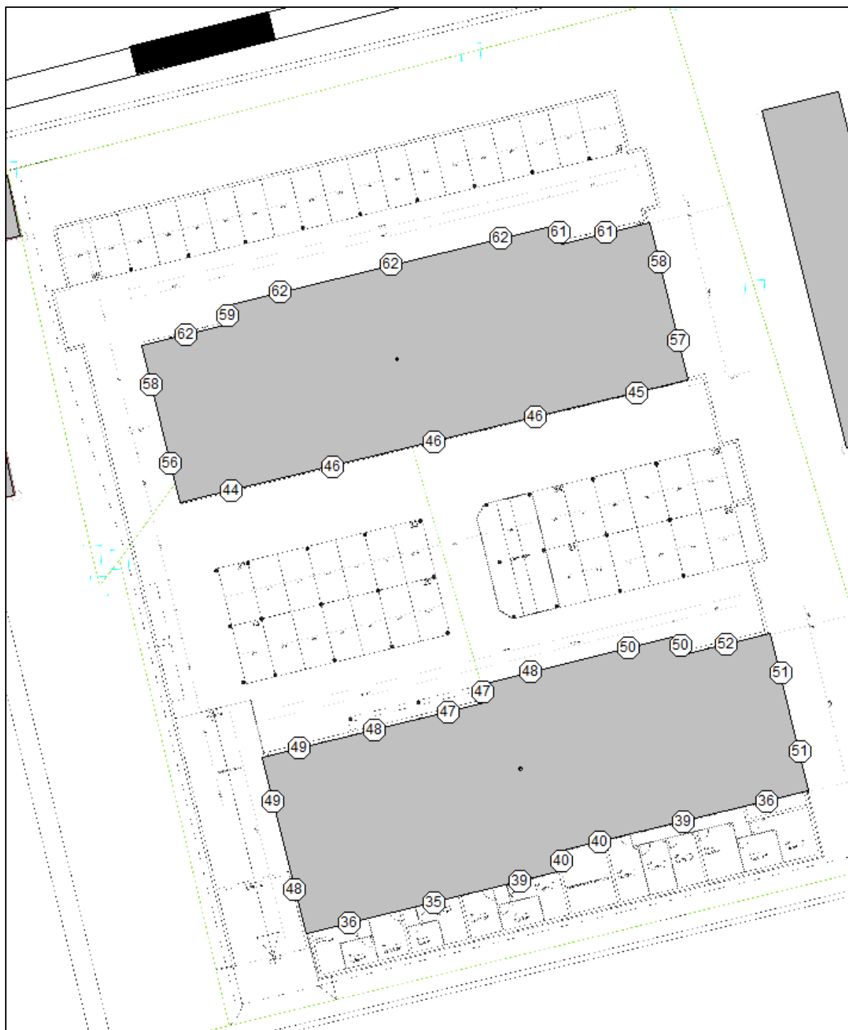
Bild 9: Gebäudelärmkarte 2. Obergeschoss, Schienenverkehrslärm nachts in dB(A)
