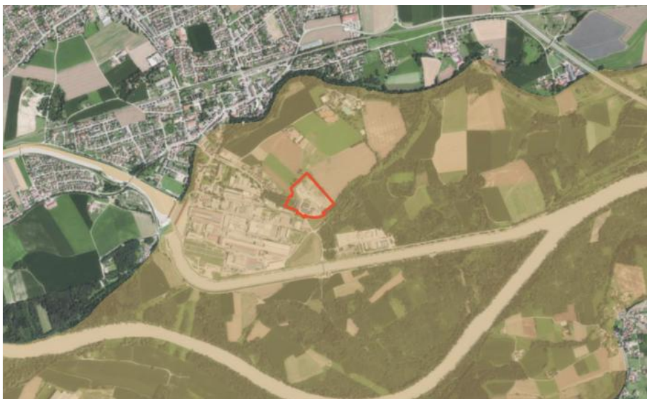
Abb. 6 Lage des Planungsgebietes im wassersensiblen Bereich (braun). Ohne Maßstab. Geobasisdaten © BvV. Quelle: BayernAtlas
